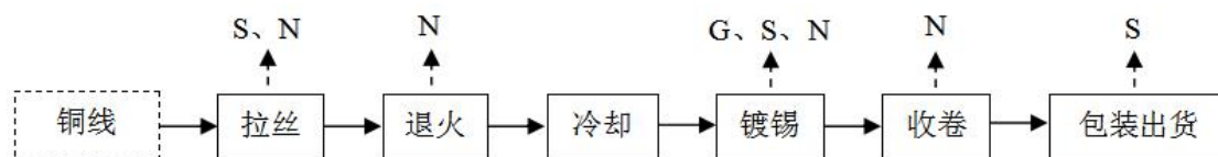
图 3-3 项目镀锡铜线生产工艺及产污环节流程图
